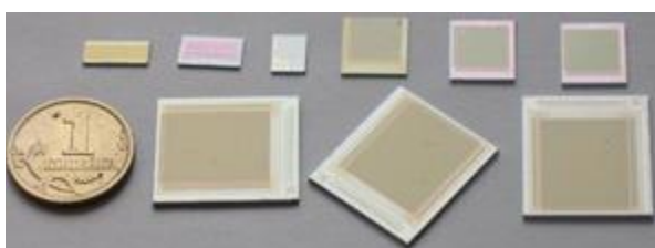
Рис.1. Типовые кристаллы мультиплексоров, разработанные в ИФП СО РАН для создания ИК ФП.
