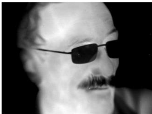
Рис. 1. Тепловое изображение и гистограмма NETD для фотоприемного модуля форматом 384×288.
